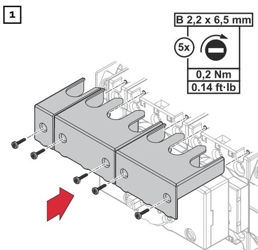
Montare su tutti i sezionatori di carico 63 A una copertura in alto ciascuno. Per il montaggio, utilizzare le viti comprese nella fornitura.
