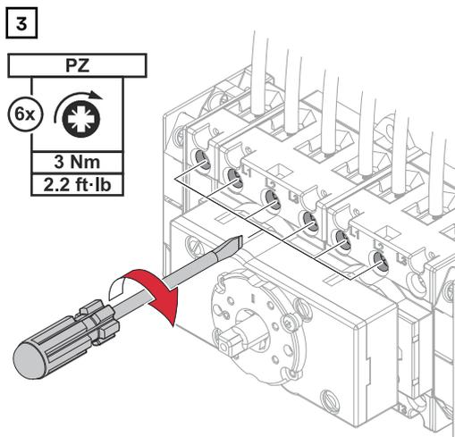
Avvitare i singoli conduttori (L1, L2, L3) e il conduttore neutro (N) nei morsetti. Avvitare i due conduttori neutri (N') nei morsetti. Per le viti di collegamento e le coppie di serraggio consentite, vedere [Viti di collegamento consentite](#) a pagina 19.
