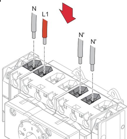
Inserire il singolo conduttore (L1) che parte dalla rete e il conduttore neutro (N) che parte dalla rete nei morsetti.
