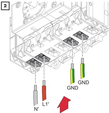
Inserire il singolo conduttore (L1') che parte dal circuito di alimentazione di backup e il conduttore neutro (N') che parte dal circuito di alimentazione di backup nei morsetti. Inserire i cavi di messa a terra (GND) del cablaggio domestico nei morsetti.
