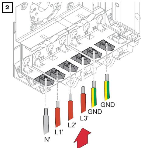
Inserire i singoli conduttori (L1', L2', L3') che partono dal circuito di alimentazione di backup e il conduttore neutro (N') che parte dal circuito di alimentazione di backup nei morsetti. Inserire i cavi di messa a terra (GND) del cablaggio domestico negli appositi morsetti.
