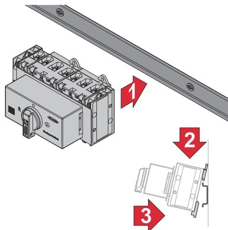
È possibile montare Fronius Backup Switch su una guida DIN da 35 mm.
