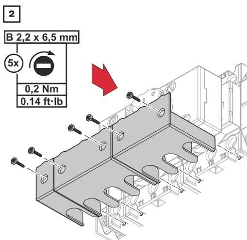
Montare su tutti i sezionatori di carico 63 A una copertura in basso ciascuno. Per il montaggio, utilizzare le viti comprese nella fornitura.
