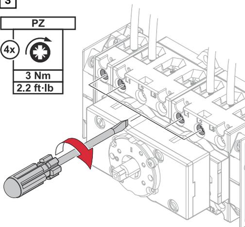
Avvitare il singolo conduttore (L1) e il conduttore neutro (N) nei morsetti. Avvitare i due conduttori neutri (N') nei morsetti. Per le viti di collegamento e le coppie di serraggio consentite, vedere [Viti di collegamento consentite](#) a pagina 19.
