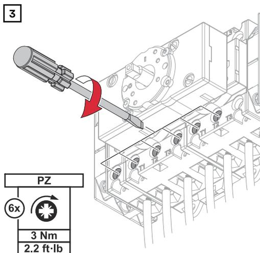
Avvitare i singoli conduttori (L1', L2', L3') e il conduttore neutro (N') nei morsetti. Avvitare i cavi di messa a terra (GND) del cablaggio domestico nei morsetti.
