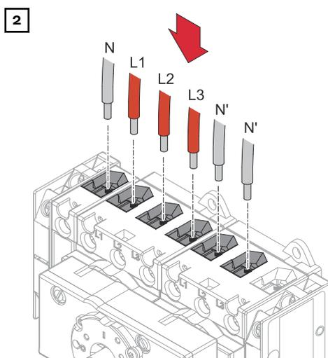
Inserire i singoli conduttori (L1, L2, L3) che partono dalla rete e il conduttore neutro (N) che parte dalla rete nei morsetti. Inserire i due conduttori neutri (N') del circuito di alimentazione di backup nei morsetti.
